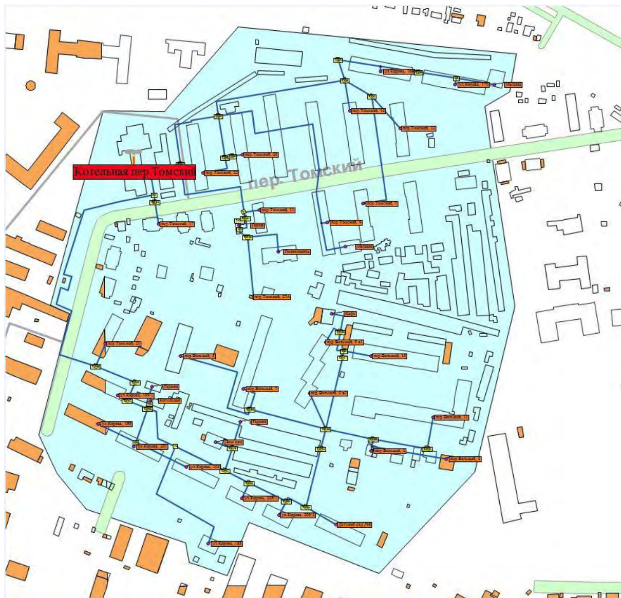
Рисунок 30 Схема теплоснабжения объектов от котельной «Томская» ООО «Городские энергетические сети»
